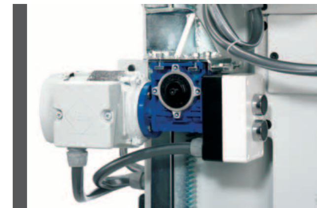
Caricamento motorizzato della sega Automatic blade loading Chargement automatique de la lame Automatische Sägeblattladung Carga automática de la cinta
